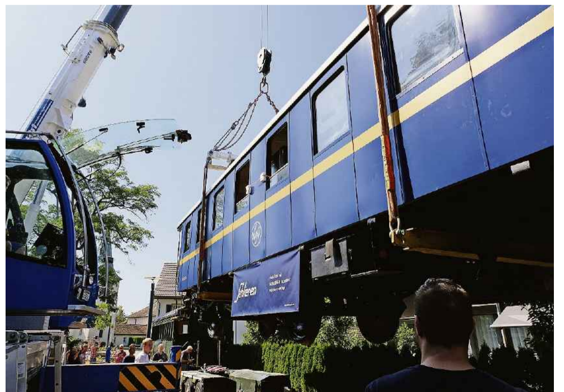
Zwei Pneuکرanen hieven den Wagen WR. 8952 vom Schwertransporter.
